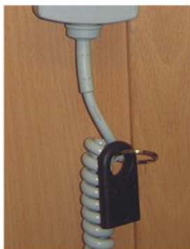
Obrázek 17. Magnetický klíč pro ovladač DEWERT IPROXX
