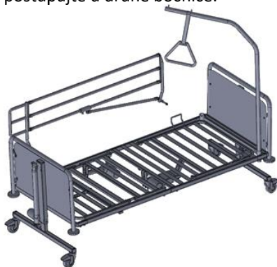
Obrázek 8. Sestavení kovových bočnic
